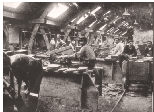
Découpe et rondissage des ardoises. Fumay (Ardennes). Début du XX e siècle. Collection Écomusée du Viroin, ULB, Treignes, 74-A.
